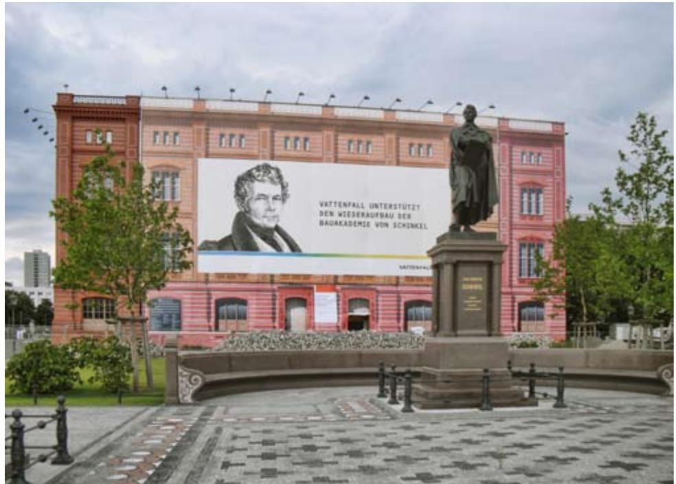
Abb. 11: 1962 beschloss die DDR-Regierung, die Bauakademie von Karl Friedrich Schinkel (1831-36) abzureißen. 2004 wurde vom Verein Internationale Bauakademie Berlin e.V. die Schaufassade der Bauakademie fertig gestellt, eine aufwendige Gerüstkonstruktion mit bedruckten Planen in den Originalmaßen.
